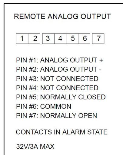
**Figura 2. Configurazione piedini allarme remoto**
